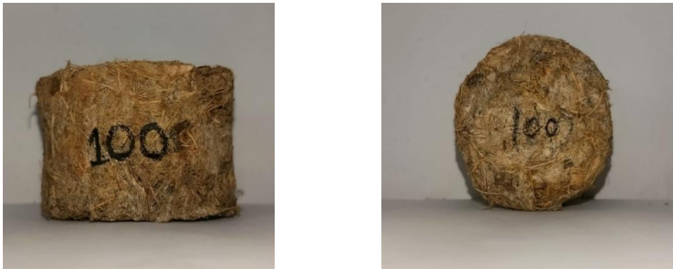
Fig 3.6. 100% areca husk briquette
